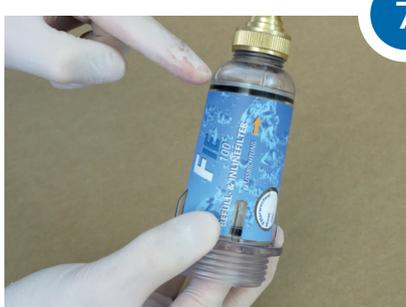
Drücken Sie die Kartusche (6) mittels Distanzring nach oben – **WICHTIG: Der O-Ring FK (7) muss im oberen Bereich umlaufend sichtbar sein**
