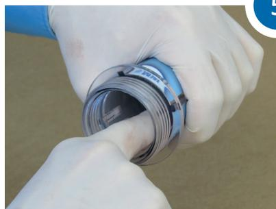
Verteilen Sie das Montagefett gleichmäßig im Filtergehäuse (9)
