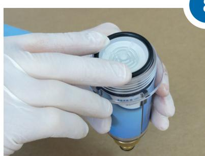
Montieren Sie das Filtersieb RW (4) darauf (Nippel nach oben) und bringen den O-Ring RW (3) an
