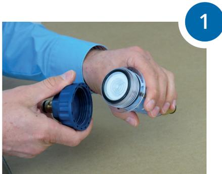
Schrauben Sie den Schraubverschluss (2) vom Filter ab
