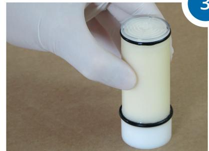
Stellen Sie die neue Filterkartusche (6) inklusive Filtersieb FT (8) mittig auf den Distanzring (5)
