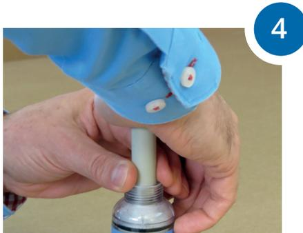
Stellen Sie das Filtergehäuse auf eine flache Unterlage und drücken Sie mittels Demontage-Rohr (12) die Filterkartusche vorsichtig heraus (inkl. beider O-Ringe). Entsorgen Sie die Filterkartusche und die beiden O-Ringe über den Hausmüll.
