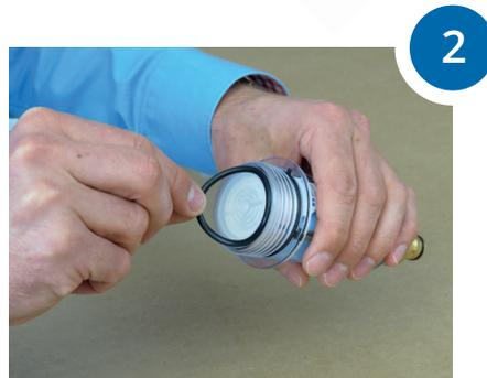
Entfernen Sie den O-Ring RW (3), das Filtersieb RW (4) und den Distanzring (5)
