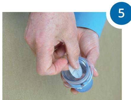
Legen Sie das Filtersieb FT (8) und den Distanzring (5) lose in das Filtergehäuse (9)
